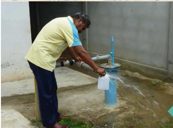
ภาพที่ 7 การเก็บตัวอย่างน้ำใต้ดินหรือน้ำประปาสำหรับการส่งห้องปฏิบัติการ
