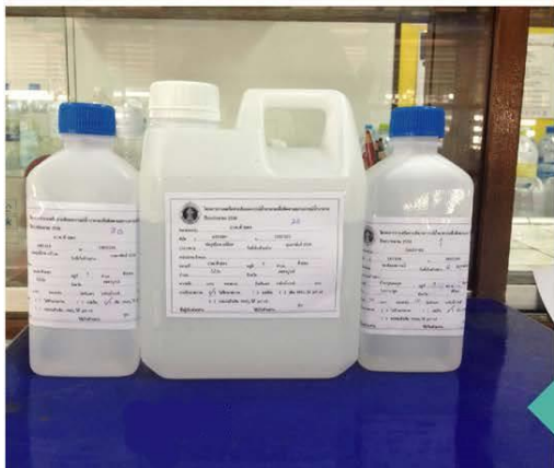
ภาพที่ 7.1 การเก็บตัวอย่างน้ำใต้ดินหรือน้ำประปาสำหรับการส่งห้องปฏิบัติการ
