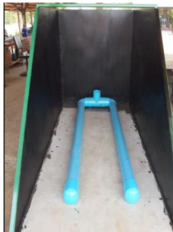
ท่อพีวีซีขนาด 4 นิ้ว เจาะรูด้านบน ระยะห่าง 5 เซนติเมตร สำหรับระบายลม
